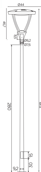
MLS LB 22A LED 45 W Strumień świetlny: 3700 lm / Luminous flux (słup z głowicą / pole with head)
